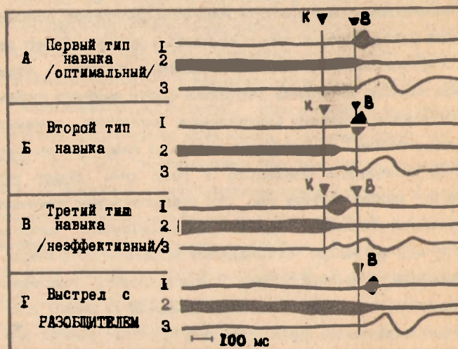
Рис. 6. Модельные характеристики биоэлектрической активности мышц лучника при различных состояниях двигательного навыка и при выстреле с устройством "разобщитель": 1 - большая грудная, левая (верхние пучки); 2 - дельтовидная мышца, левая (задние пучки); 3 - механограммы устойчивости системы "стрелок-оружие" в горизонтальной плоскости; К - момент шелчка; В - момент разрыва ЗКЦ (выстрела).
