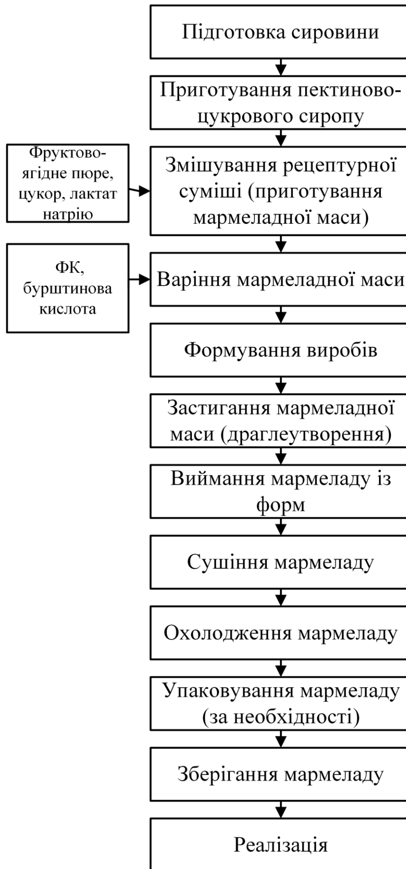
Рис. 4.9. Принципова технологічна схема виробництва мармеладу з ФК «Антистрес»
