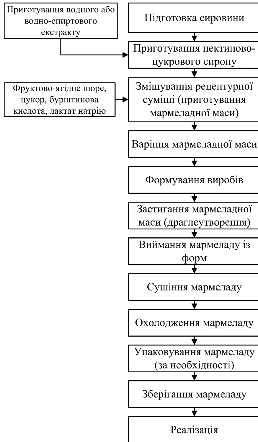
Рис. 4.12. Принципова технологічна схема виробництва желейно-фруктового формового мармеладу з екстрактами ФК адаптогенної дії «Антистрес».
