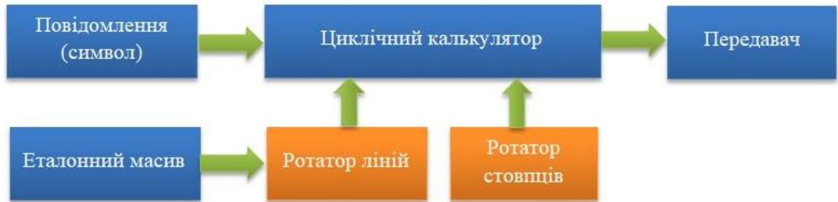
Рис. 1.1. Принцип модуляції інформації на основі циклічного обертання ідеальних двійкових масивів
