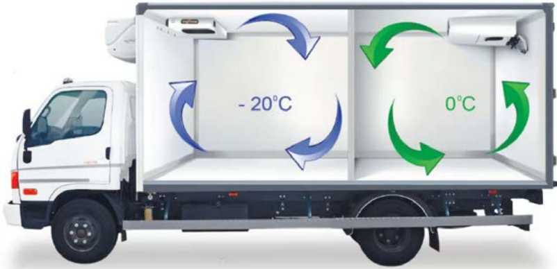
Рис. 11.8. Холодильний транспортний засіб, що охолоджується холодильною машиною
