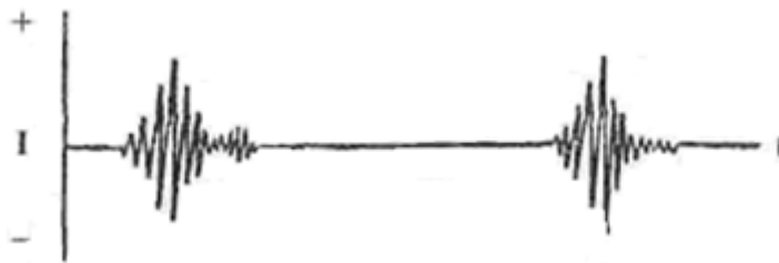
Рис. 9.4. Форма імпульсів, що використовуються при дарсонвалізації
