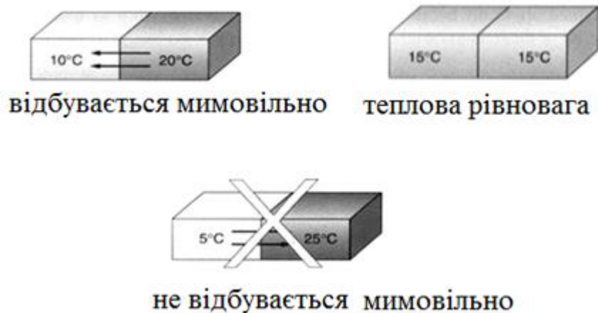
Рис. 1.4. Передача теплоти згідно з другим законом термодинаміки
