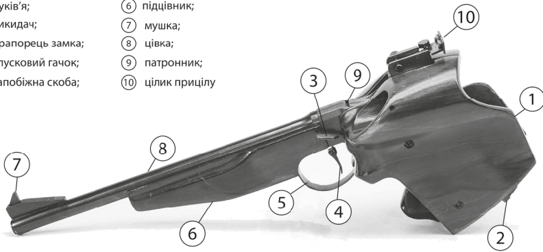
Рис. 4.4. Будова довільного спортивного малокаліберного пістолета
