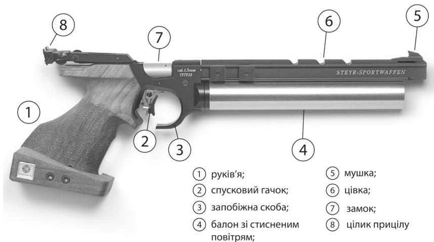
Рис. 4.2. Будова спортивного пневматичного пістолета
