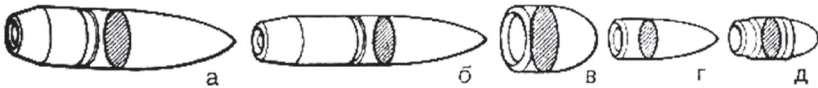
Рис. 3.37. Площа поперечного перерізу кулі : а-д – різного калібру, де д – для спортивної малокаліберної гвинтівки калібру 5,6 мм
