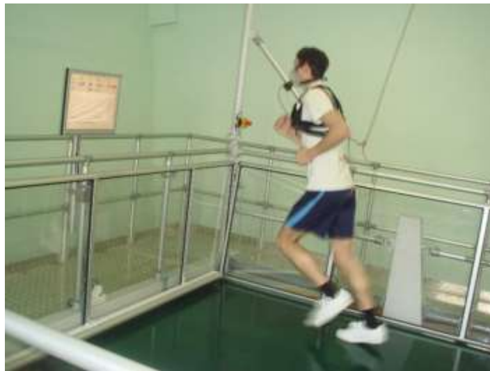
Рис. 1.4. Біговий ергометр, поєднаний з газоаналітичним устаткуванням BetaMax 3B Cortex
