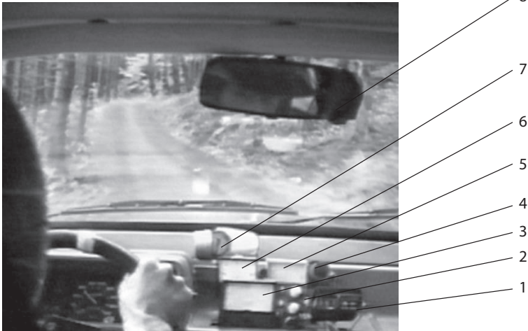
Рис. 11.1. Автомобіль-лабораторія для визначення механічних навантажень на тіло водія і пасажирів: 1 – електронний тахометр; 2 – блок налаштування мостових схем акселерометрів; 3 – вказівник положення педалі акселерації; 4 – сигнальна лампа спрацьовування педалі гальма; 5 – вказівник горизонтальних прискорень; 6 – вказівник вертикальних прискорень; 7 – манометр тиску в гальмівній системі; 8 – електронний хронометр – мілісекундомір
