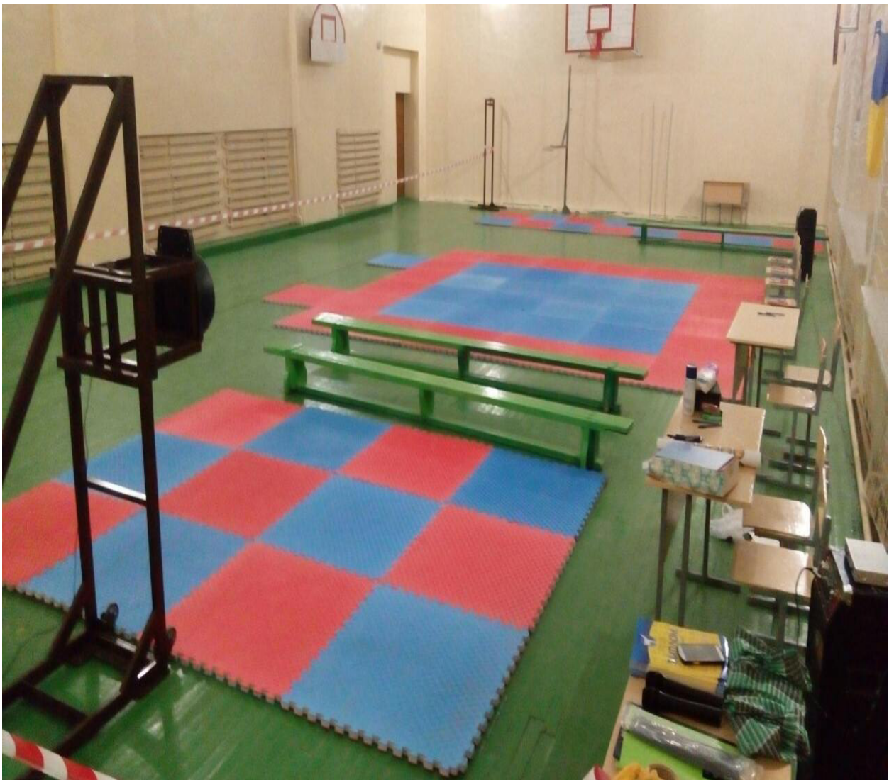
Рисунок 2.2 . Тренажер» «Атака» з використанням стійки №1 Діапазон різкості вимірюваних ударів – 30 – 300 кг/мс. Діапазон енергії вимірюваних ударів – 20-300 Дж.
