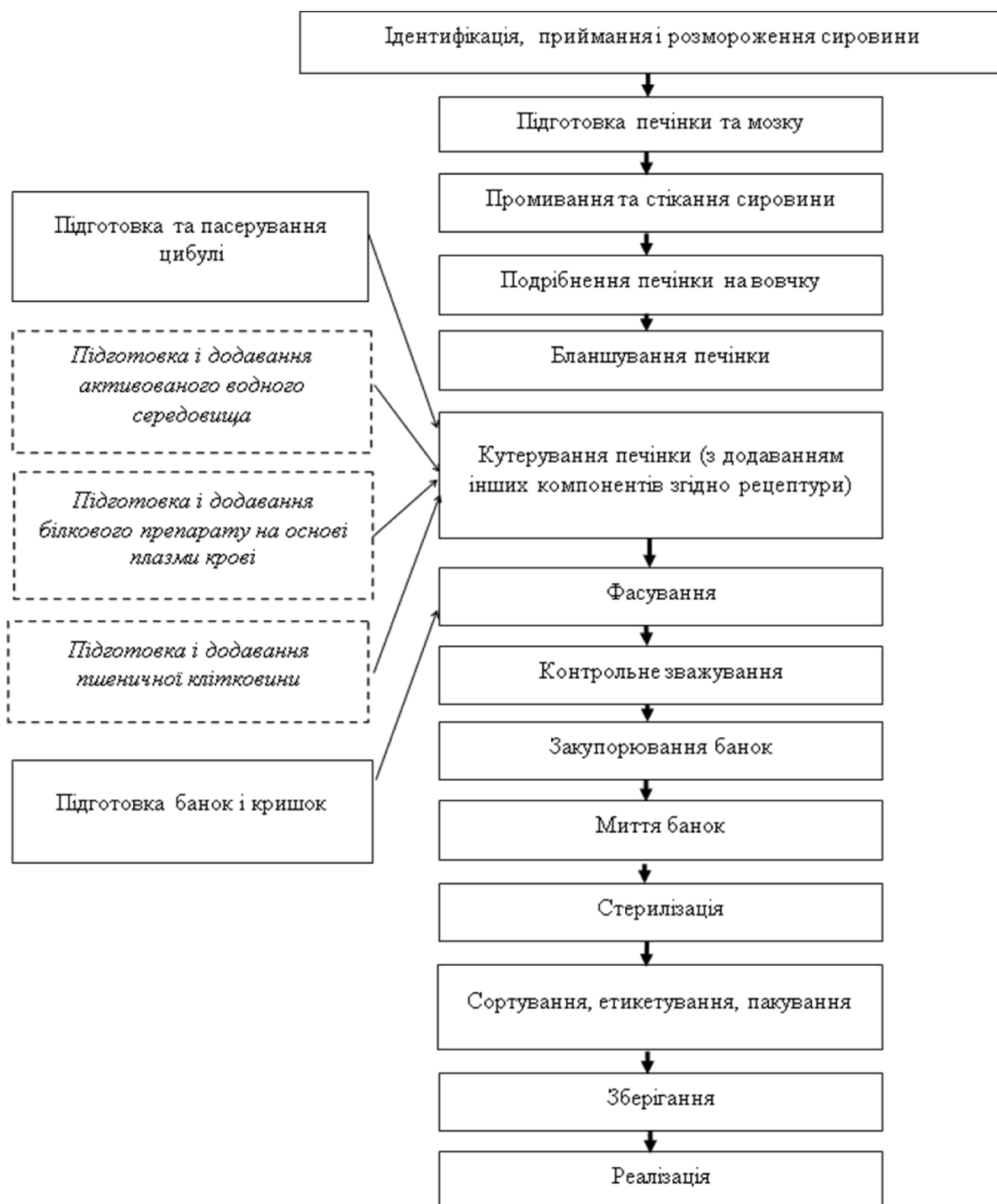
Рис. 1. Технологічна схема виробництва пащтетних консервів із додаванням білкового препарату плазми крові та нерозчинних харчових волокон
