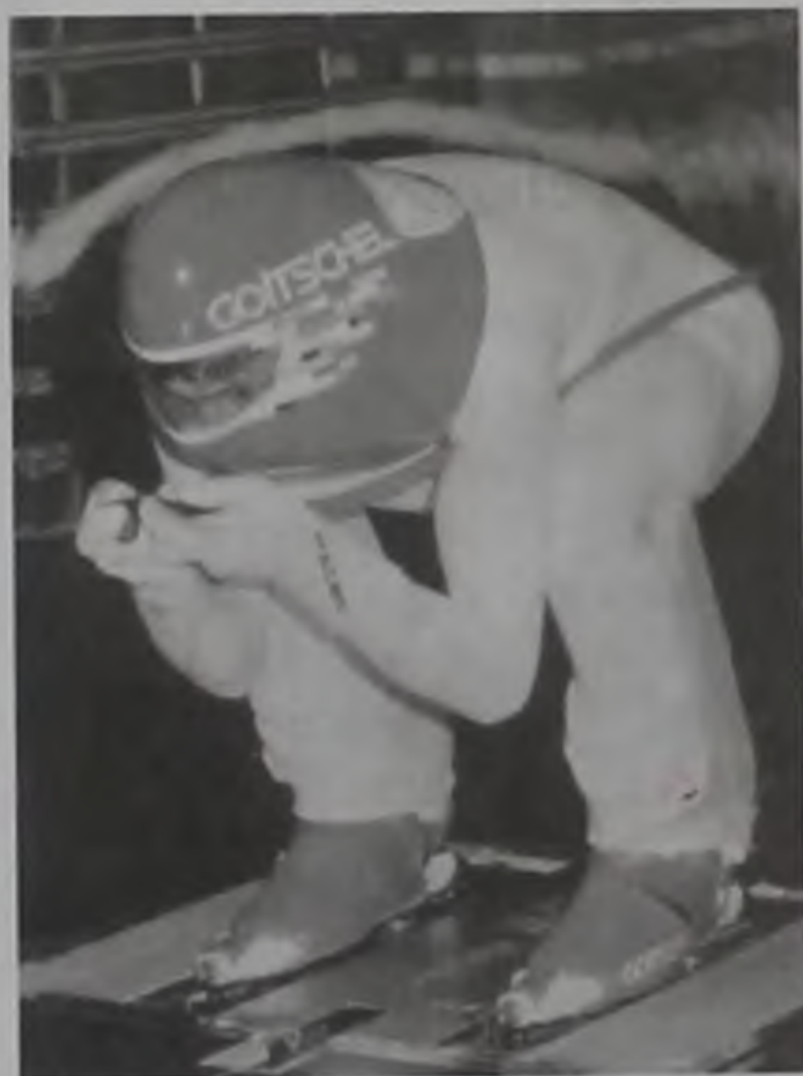
Рис. 42.13. Исследование обтекаемости тела горнолыжника в аэродинамической трубе
