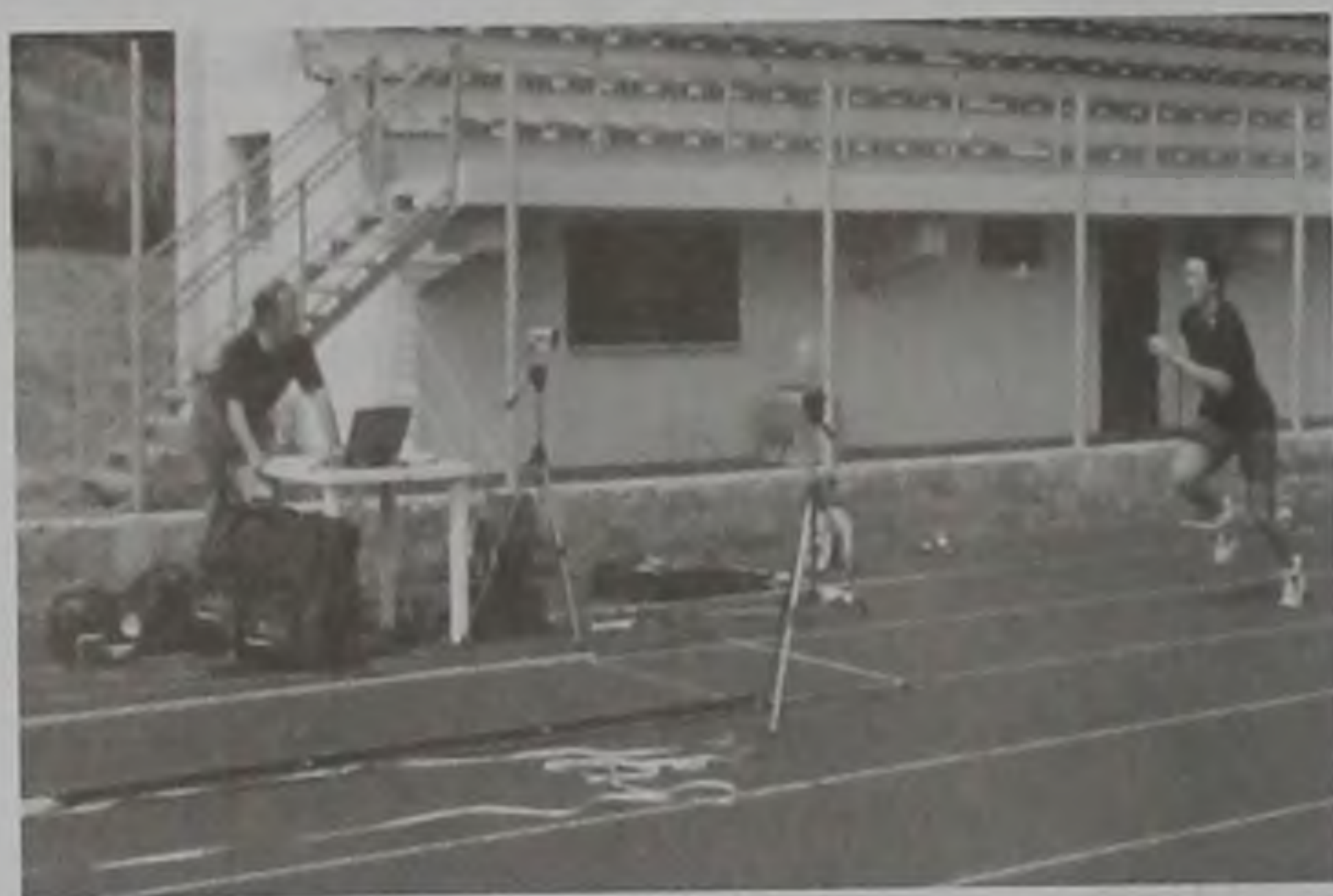
Рис. 16.11. Диагностический комплекс для оценки эффективности ударов в боксе: 1 — трехмерная динамометрическая платформа; 2 — лампы для измерения тени движения; 3 — приемное устройство для измерения тени движения; 4 — сигнальная лампа для измерения времени реакции «старт»; 5 — система, регулирующая высоту размещения платформы (Berger, 1994)
