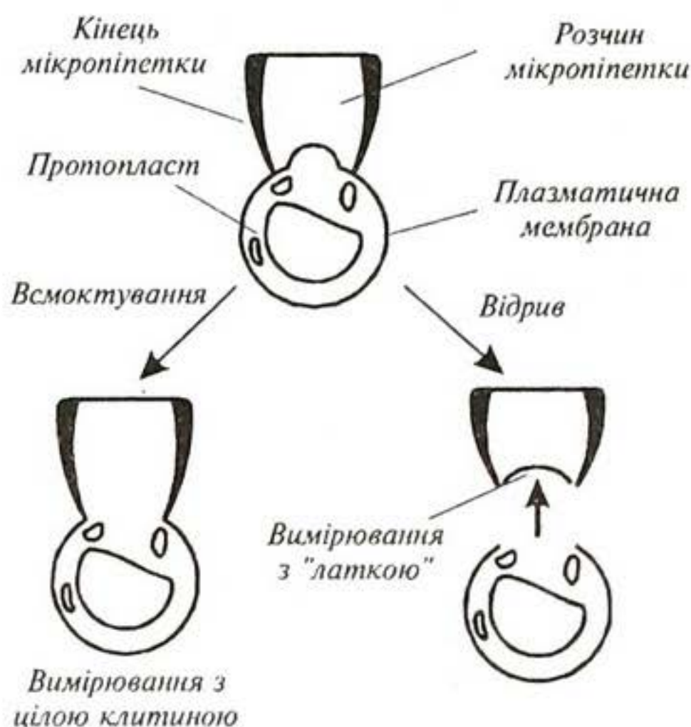
Рис. 20.12. Принцип кетч-клемп-методу реєстрації мембранних струмів (пояснення в тексті)
