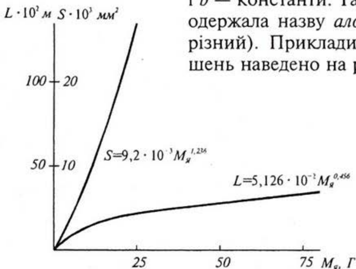
Рис. 3.1. Алометричні співвідношення між фізіологічними ( L — довжина пор; S — площа пор шкаралупи яйця) і механічними ( M_{\text{я}} — маса яйця) параметрами для двох значень коефіцієнта b ( b = 1,236 > 1 і b = 0,456 < 1 )
