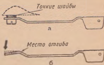
Рис. 31. Способы уменьшения натяжения спуска:
