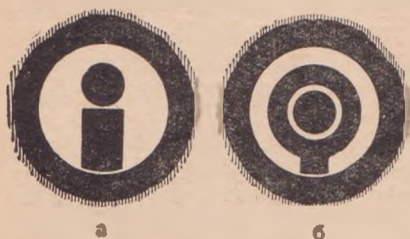
Рис. 311. Схема прицеливания при диоптрическом прицеле: а — при прямоугольной мушке; б — при кольцевой мушке
