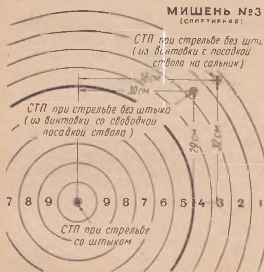
Рис. 107. Перемещение СТП при стрельбе на 300 м лежа с применением ремня из винтовки образца 1891/30 гг. со штыком и без штыка
