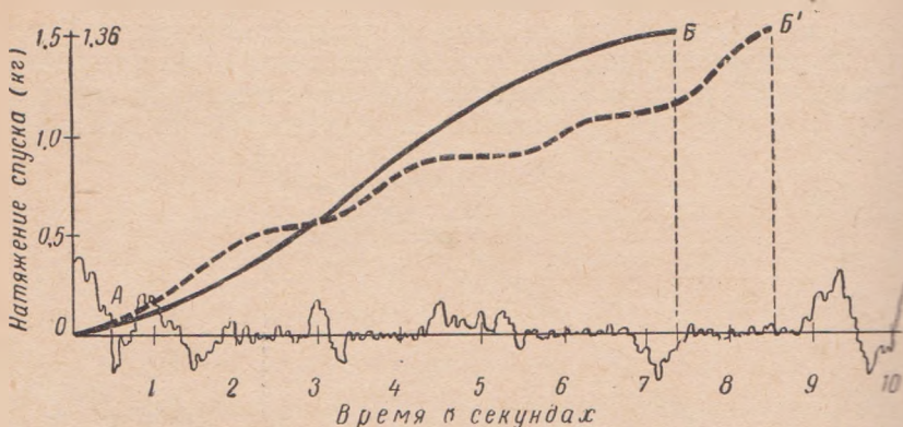
Рис. 341. Принципиальная схема управления спуском без предупреждения при стрельбе стоя из армейской винтовки и револьвера: AB — последовательно-плавный нажим на спусковой крючок; AB' — ступенчато-последовательный нажим на спусковой крючок
