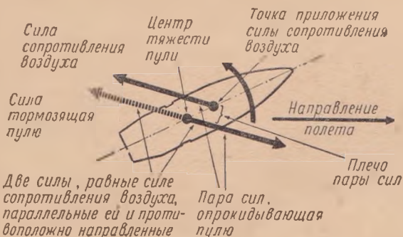
Рис. 119. Опрокидывающее действие силы сопротивления воздуха на летящую пулю
