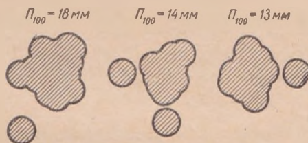
Рис. 89. Рассеивание пуль при отстреле 5,6-мм патронов бокового огня на 50 м сериями по 20 выстрелов (натуральная величина): целевые патроны
