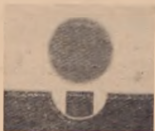
Рис. 310. Схематическое изображение восприятия глазом прореза, мушки и «яблока» мишени при стрельбе из револьвера на 25 м, когда взгляд отфокусирован на прицельные приспособления
