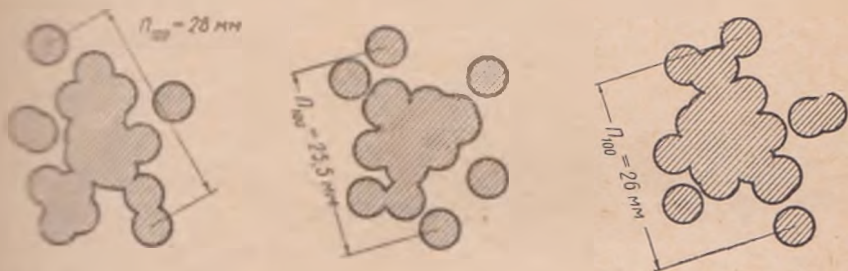
Рис. 91. Рассеивание пуль при отстреле 5,6-мм пистолетного целевого укороченного патрона бокового огня на 25 м сериями по 20 выстрелов (натуральная величина)
