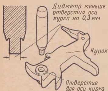
Рис. 61. Обжимка для уменьшения отверстия для оси курка
