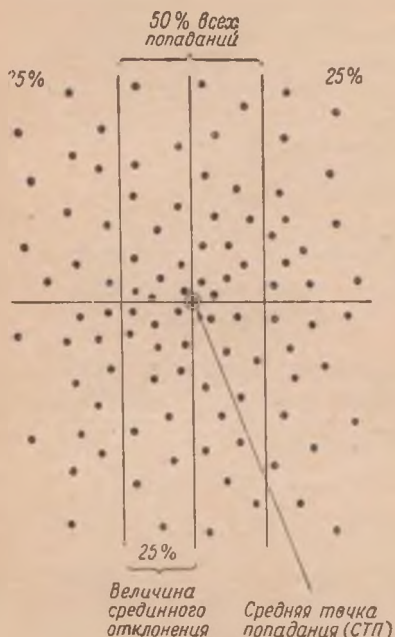
Рис. 146. Величина срединного (вероятного) отклонения — половина ширины полосы лучшей половины пробоя
