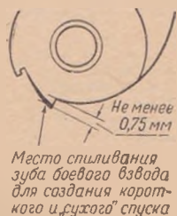
Рис. 71. Подпиливание зуба боевого взвода курка для устранения потяжки
