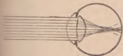
Рис. 298. Явление сферической аберрации
