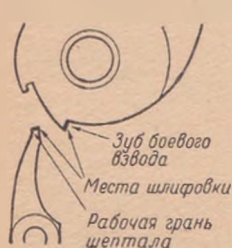
Рис. 70. Заправка мест зацепления боевого взвода курка и рабочей грани шептала для облегчения спуска
