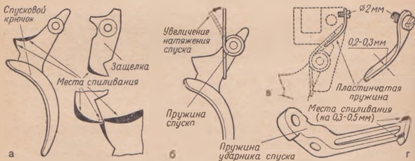
Рис. 44. Обработка деталей спускового механизма для устранения биения спускового крючка на палец и „провала“ спускового крючка (способ оружейного мастера А. Данилова)
