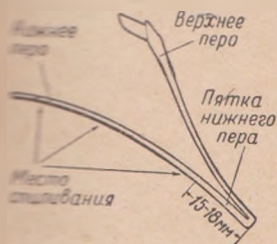
Рис. 63. Обработка нижнего пера боевой пружины для облегчения спуска
