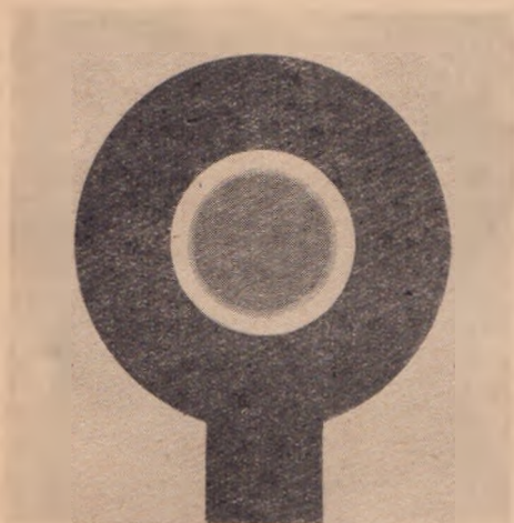
Рис. 319. Схематическое изображение восприятия глазом кольцевого просвета между мушкой и «яблоком» при неярком освещении (пасмурная погода)
