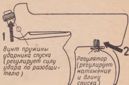
Рис. 45. Последовательность регулирования ударно-спускового механизма винтовок «Стрела», «Зенит», «Тайга»
