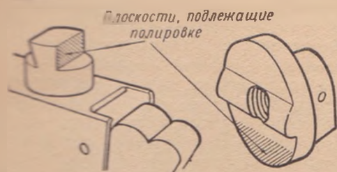
Рис. 30. Подгонка и полировка соприкасающихся между собой поверхностей боевого взвода курка и шептала
