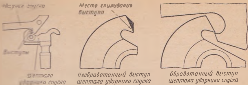
Рис. 36. Изменение формы выступа шептала ударника спуска
