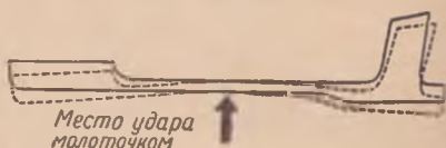
Рис. 23. Отгиб спусковой пружины для уменьшения натяжения спуска
