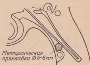
Рис. 65. Установка металлической прокладки для облегчения спуска
