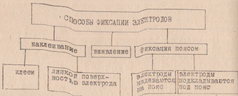
Рис. 27. Способы фиксации электродов при регистрации биопотенциалов у спортсмена.
