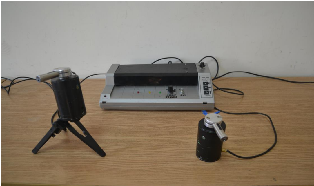
Рис. 2.1. Спеціальний пристрій для проведення «холостої стрільби» на круглому стенді
