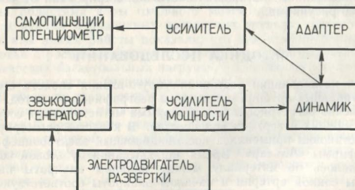
Рис. 1. Блок-схема устройства для изучения механических свойств костной ткани.
