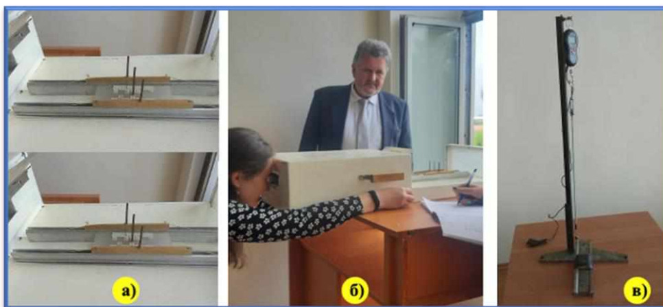
Рис. 5. Стереометр (а, б) і тензометрична педаль (в) для оцінювання рівня розвитку стереоскопічного зору і кінестезійних відчуттів.
