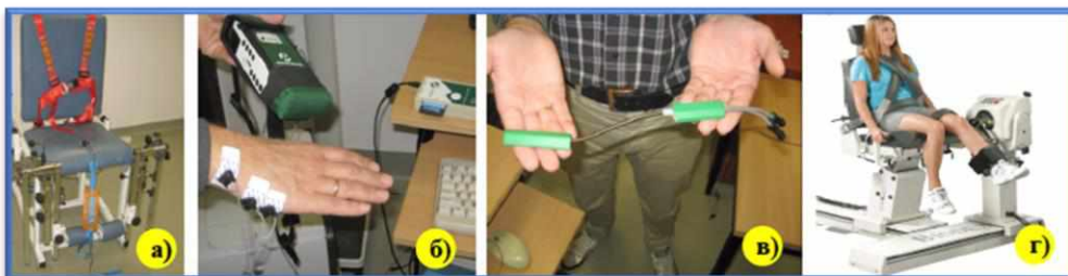
Рис. 4. Стенд ОРІВ для дослідження моментів м'язових сил у колінних суглобах (а); система реєстрації показників ЕМГ Octopus (б); електрогоніометр (в); комплекс BIODEX SYSTEM 4 (г).
