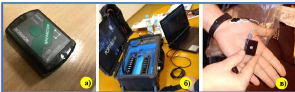
Рис. 2. Бездротовий вимірювальний комплекс Noraxon MyoMotion: а) – давач Noraxon; б) – приймач радіосигналу з інтерфейсом та ноутбуком; в) – давачі для реєстрації ЕМГ.
