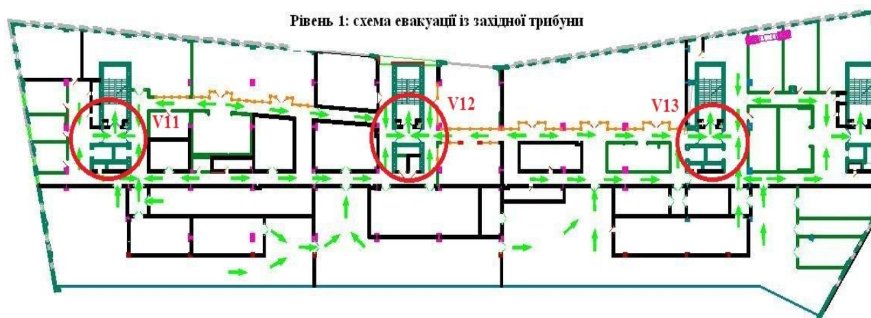
Рис. 4.3.2. Схема розташування «вузьких» місць на евакуаційних маршрутах першого рівня адміністративної будівлі СВС «Арена Львів»
