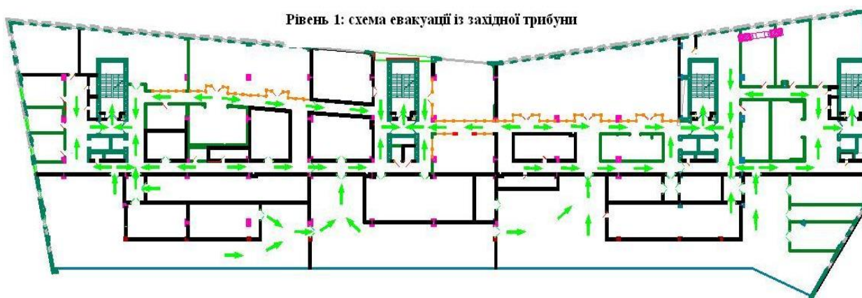
Рис. 4.2.8. План-схема управління потоками зацікавлених сторін проектів під час евакуації із першого рівня адміністративної будівлі
