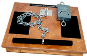
Рис. 3.15. Динамометрична система станової і ніжної сили моделі АА86139
