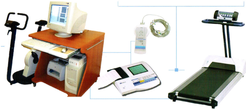
Рис. 6.20. Варіант модуля ЕКГ для стрес-тест навантаження
