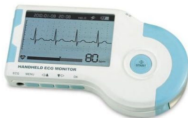
Рис. 6.7. Кишеньковий електрокардіограф із можливістю синхронного запису ЕКГ і пульсоксиметрії
