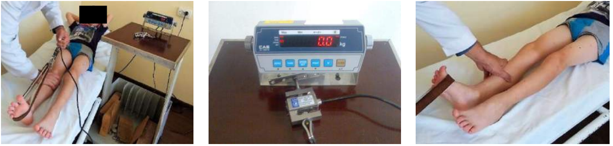
Рис. 2.7. Пристрій реєстрації величини навантаження з тензOMETричним датчиком. ТензOMETричний датчик SBA-100L.
