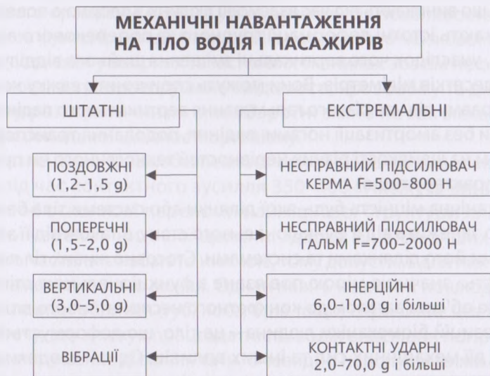
Рис. 11.2. Класифікація механічних навантажень та перевантажень на тіло водія і пасажирів транспортного засобу
