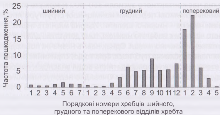
Рис. 11.3. Частота пошкодження хребців пілотів під час катапультування (М. М. Auffred, 1975)
