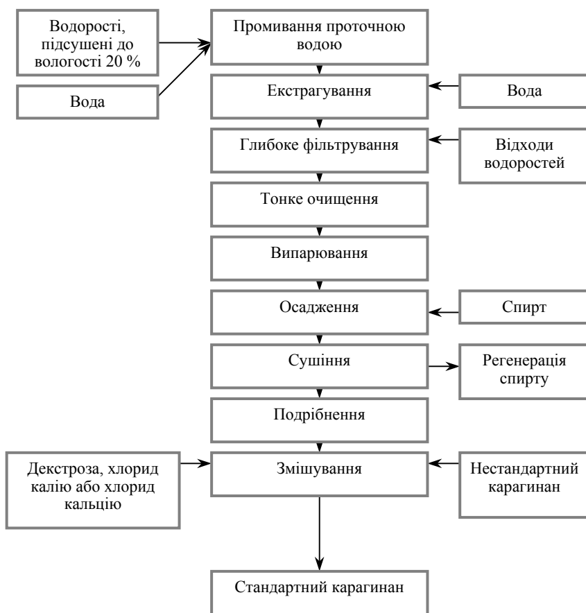
Рис. 4.5. Процес отримання карагинану
