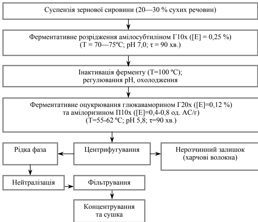
Рис. 7.2. Загальна технологічна схема виробництва глюкозних зернових сиропів
