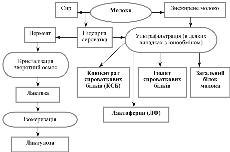
Рис. 2.8. Схема отримання продуктів переробки сироватки за мембранною технологією
