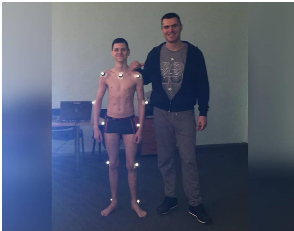
Рис. 2.1 Система тривимірного біомеханічного аналізу рухів – відеокомп'ютерний комплекс «Qualisys»
