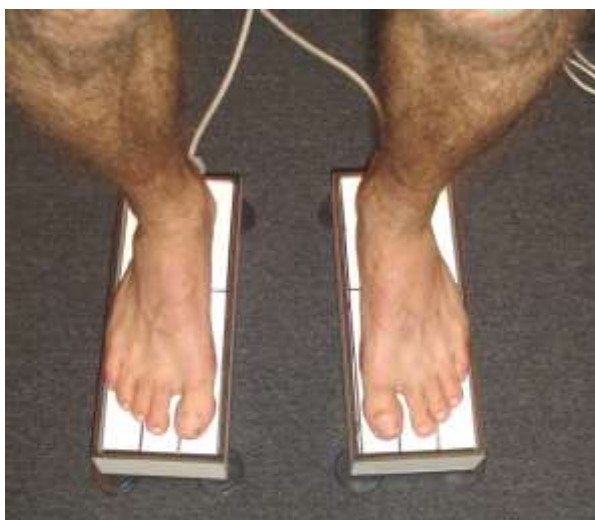
Рис. 2.8. Фото положення стоп пацієнта на електротензодинамометричних платформах
