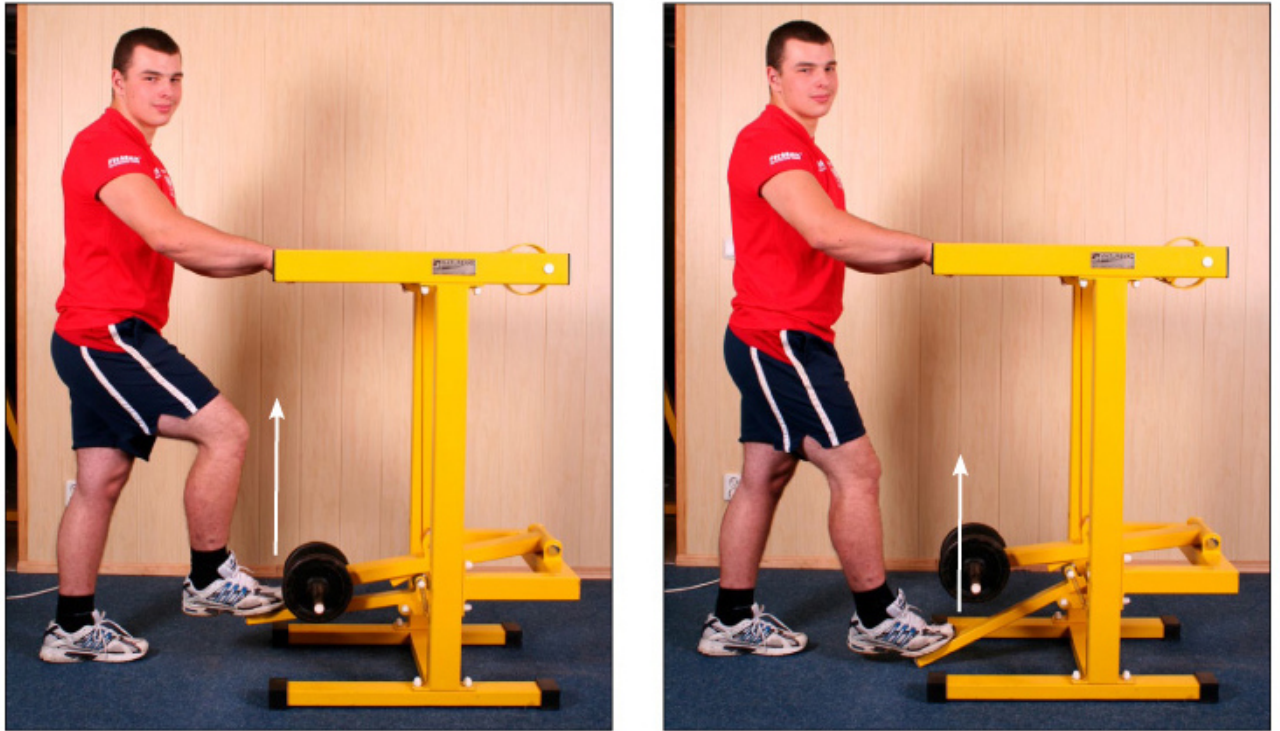
Рис. 3.9. Педаль для полегшення першого підйому обтяження
