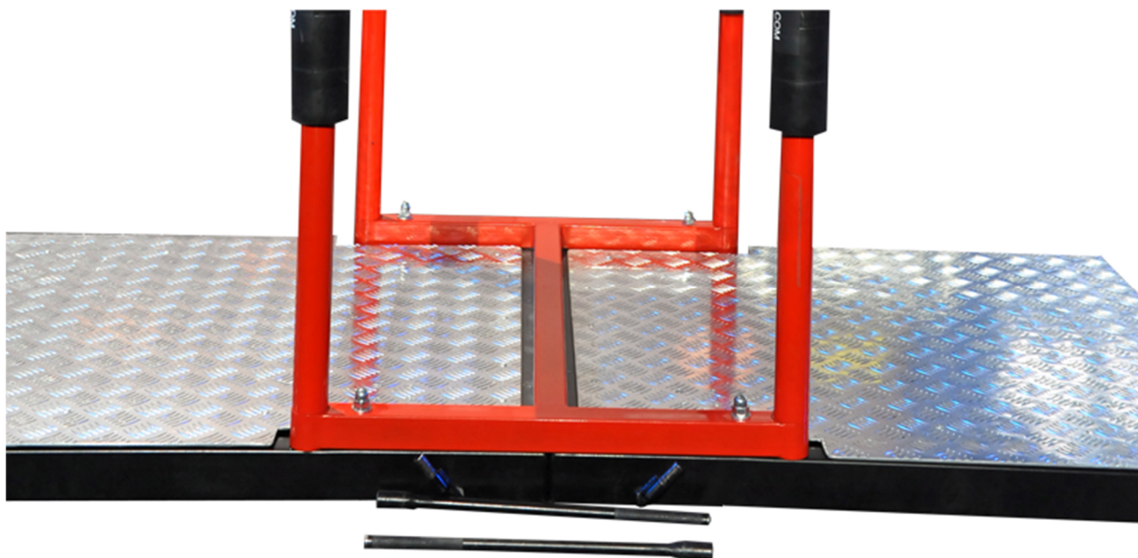
Рис. 3.2. Спеціальна автоматична платформа для кріплення столу
