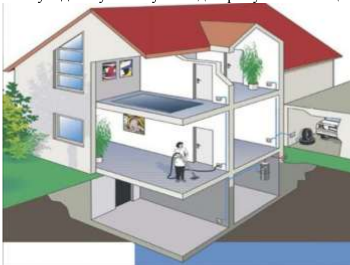
Рисунок 8 – Схема системи централізованого видалення пилу
