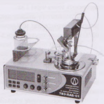
Рис. 9. Прилад Пенськи-Мартенса для визначення температури спалаху олії в закритому тиглі.
