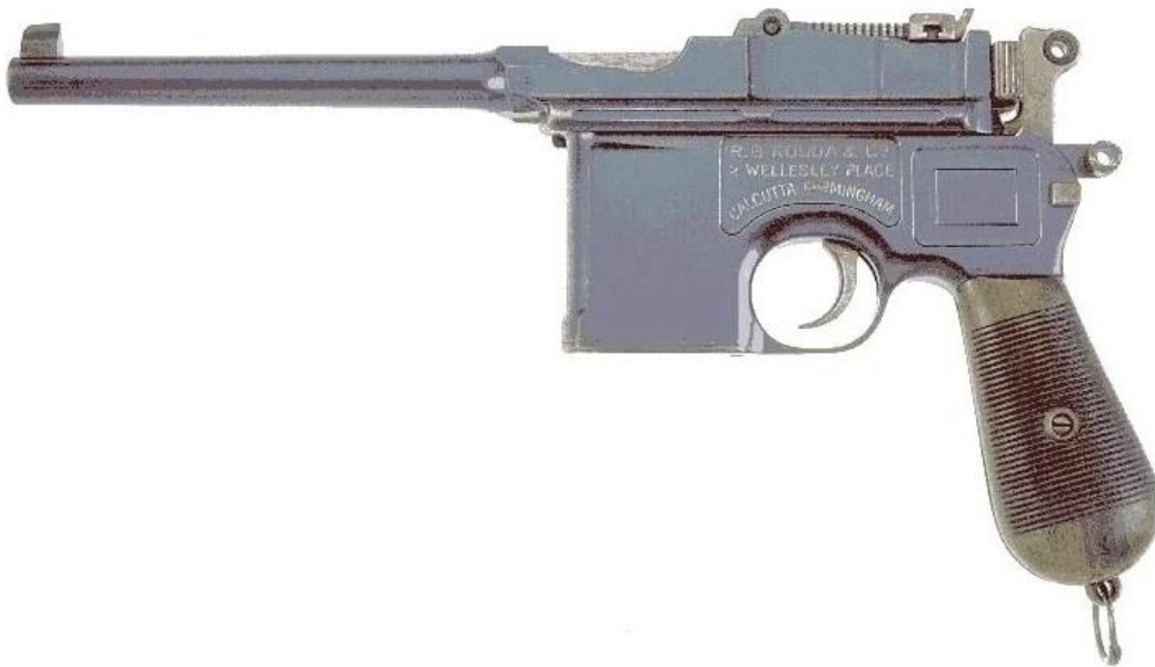
Рис. 1.6. 7,63 мм пістолет Mauser C96, Німеччина (1895 рік)
