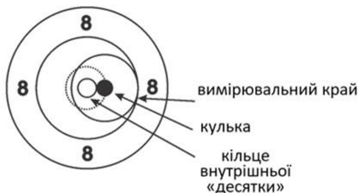
Рис. 3.5. Використання зовнішнього вимірювального засобу для визначення результатів внутрішніх “десяток” на мішені для вправ з пневматичного пістолета
