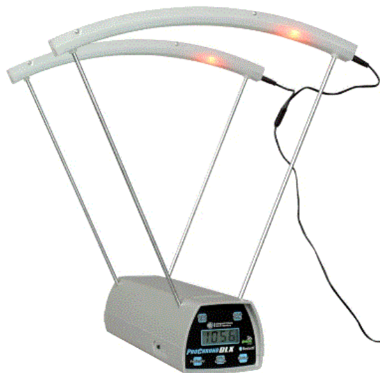
Рис.3.12. Електронний хронограф для вимірювання швидкості вильоту кулі
