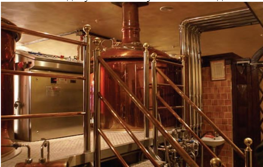
Рис.7.1. Суслотварильний апарат міні-пивзаводу
