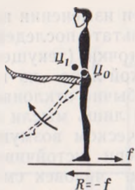
Рис. 45. Возникновение горизонтальной составляющей реакции опоры и смещения ц.т. тела в переменных равновесиях (мах ногой вперед)
