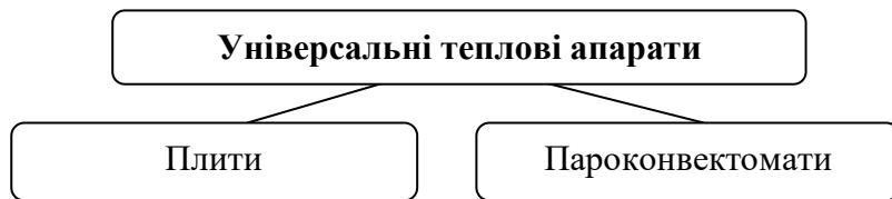
Плити за видом теплоносія поділяються на *електричні та газові*.
