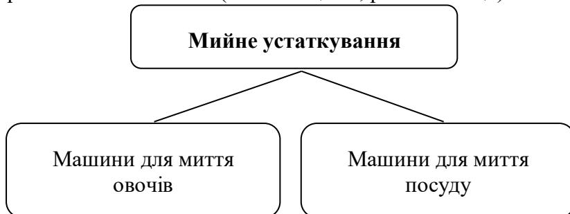
Для миття овочів використовуються *вібраційні*, *роликові*, *барабанні*, *лопатеві*, *щітково-роликові*, *мийно-очищувальні* машини.
