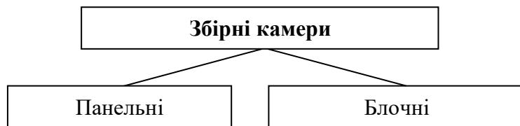
Більшого використання набули камери *панельного типу*, де кожна панель має зовнішнє стальне і внутрішнє алюмінієве облицювання, між якими залито пінополіуретан. Він застигає і утворює монолітну теплоізоляцію. Конструкція панелі виходить міцною, легкою, герметичною, безкаркасною.
