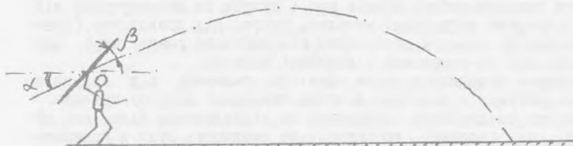
Рис. 1. Характеристики польоту спортивних приладів: \alpha - кут місцевості, \beta - кут атаки
