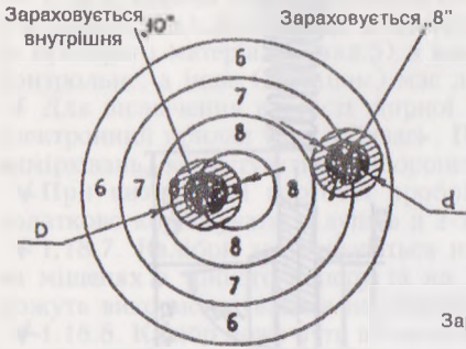
Мал.6. Використання шаблону (пневматична гвинтівка; мішень №8). Контрольний круг (d) зор'єнтований по контуру пробіни.
